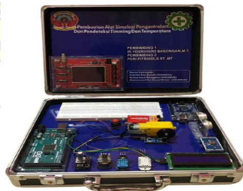
Gambar 4. 1 Alat Simulasi Pengontrolan Dan Pendeteksi Timing Dan Temperature
