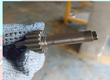
Gambar 3. 4 Gear Shaft pada Hydraulic Pump
