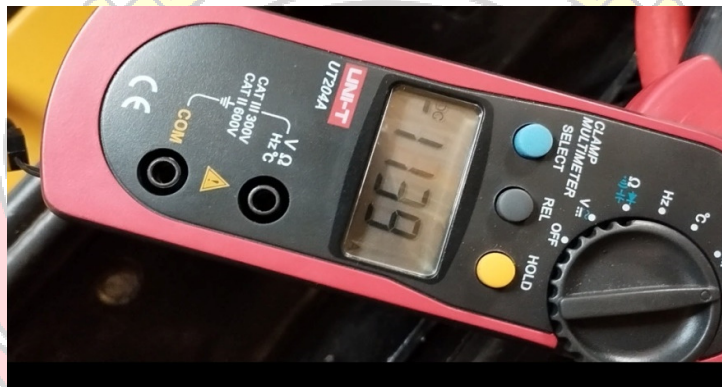
Gambar 5.6 Arus Yang Mengalir Pada Saat Star 1
