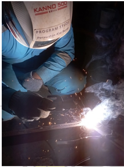
Gambar 4.7 Pengelasan Besi Siku
