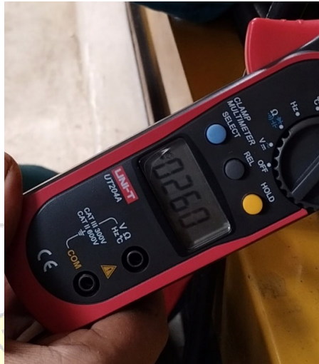
Gambar 5.8 Arus Yang Mengalir Pada Saat Star 3
