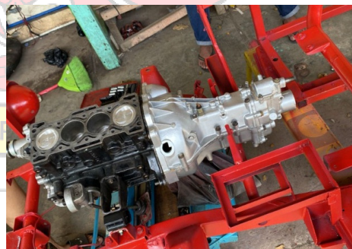
Gambar 3. 12 Pemasangan Transmisi Ke Mesin
