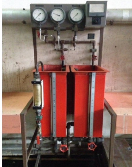
Gambar 1. Mesin thermal ejector rig pada laboratorium pengukuran thermal setelah perbaikan politeknik Negeri Ujung Pandang.
