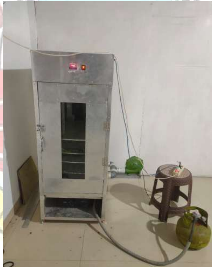
Gambar 4.1 Oven Pengering Daun Kelor menggunakan pemanas Gas LPG
