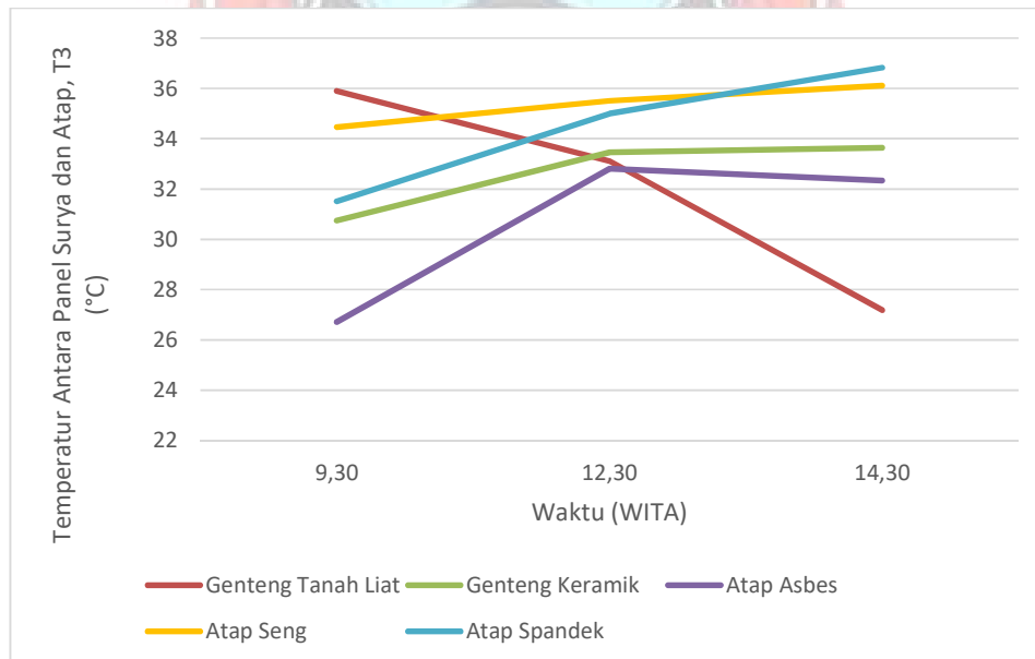
Gambar 4.17 Perbandingan Karakteristik Temperatur Untuk Jarak 30 cm pada Berbagai Jenis Material Atap
