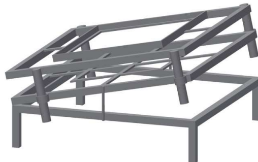
Gambar 3.1 Desain Alat Kerangka Panel Surya dan Atap
