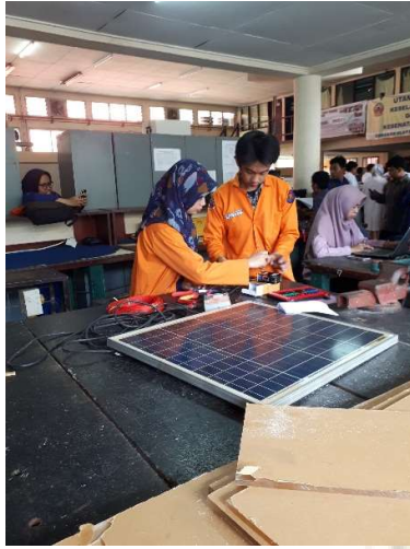
Pengecekan data logger arus dan tegangan
