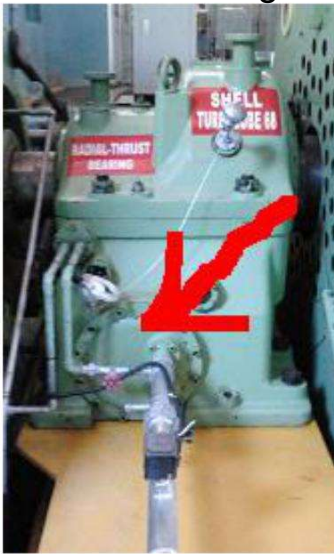
7. tutup valve yang menuju ke radial guide bearing dan radial thrust bearing
