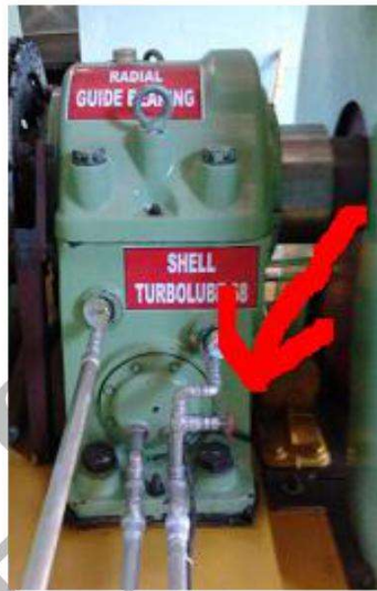
7. tutup valve yang menuju ke radial guide bearing dan radial thrust bearing
