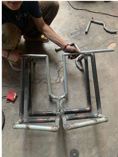
Pembuatan rangka dudukan kursi roda
