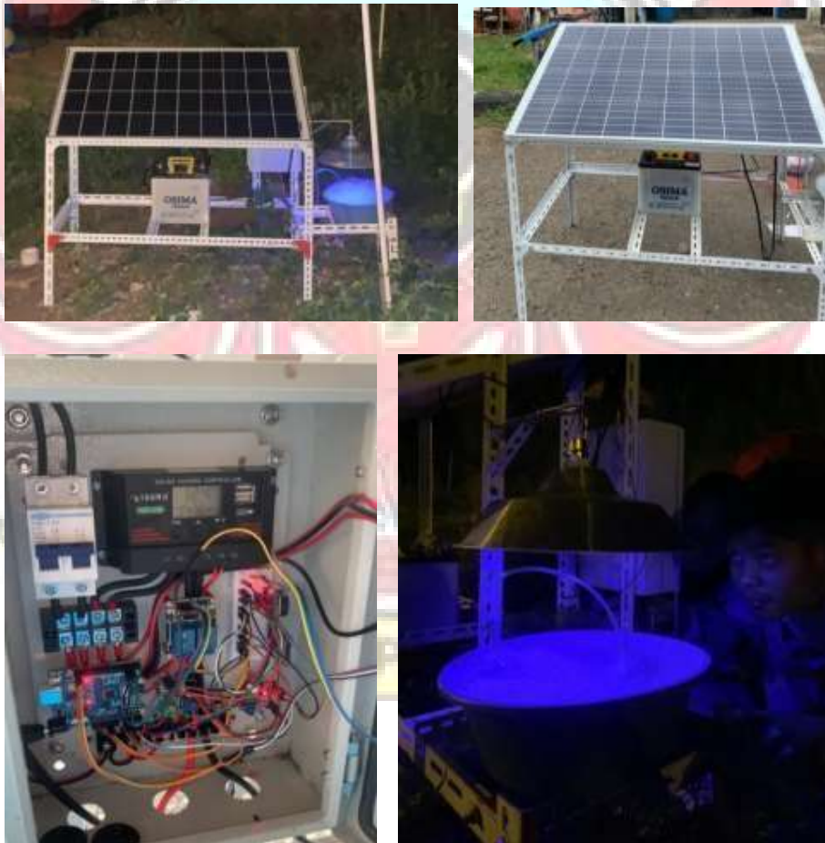
Gambar 4.1 Alat perangkap hama pada tanaman bawang merah
