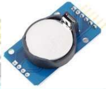
Gambar 2.12 Modul RTC DS3231 Sumber : Ladiku, 2022
