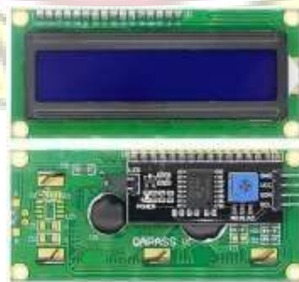
Gambar 2.16 Pemasangan Lcd dengan I2C Sumber : www.tokopedia.com
