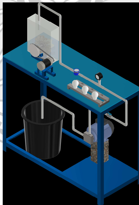
Gambar 3.2 Gambar alat simulasi PLTMH dengan sistem sirkulasi air
