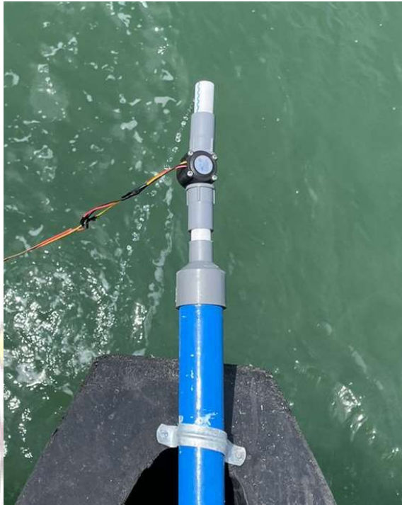
Gambar 4. 3 Sensor Waterflow (Sumber: Dokumentasi Pribadi)
