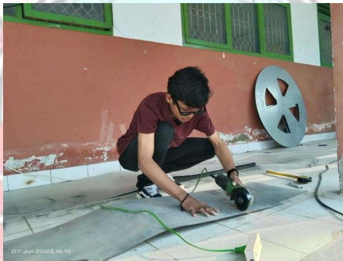
Gambar 5.1 Proses Pembuatan Sudu Kincir
