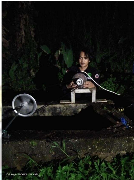
Gambar 5.8 Penyetelan Dudukan Generator
