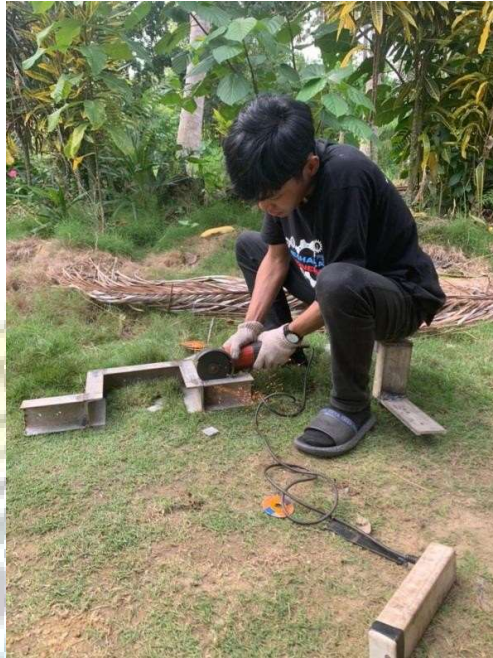
Gambar 5.2 Proses Pembuatan Sudu Kincir
