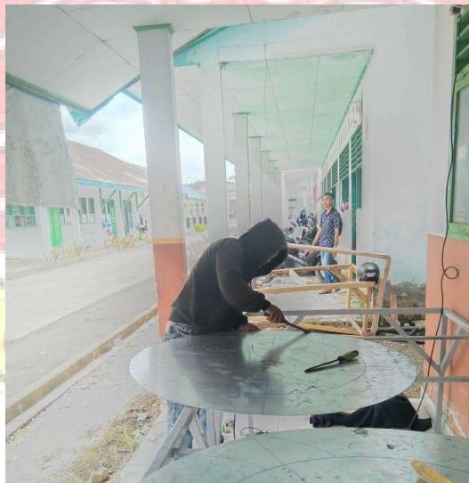
Gambar 5.3 Pemetongan Plat Kincir
