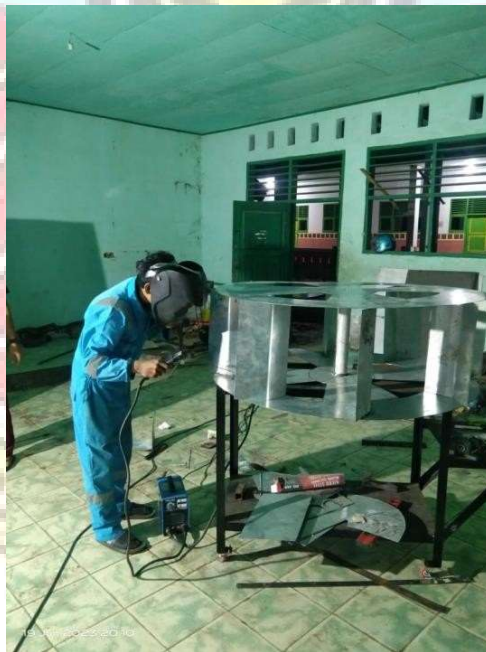
Gambar 5.5 Pengelasan Sudu Kincir/Sirip
