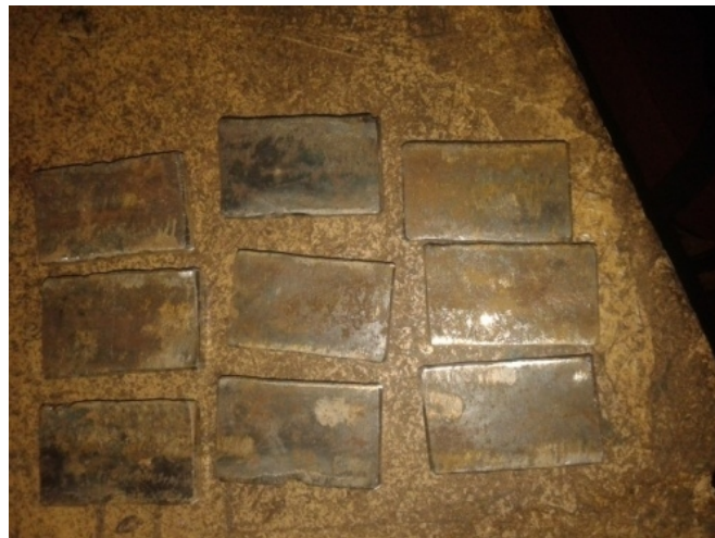
Gambar 1. Bahan Spesimen (Plate Baja JIS G3101 SS400)
