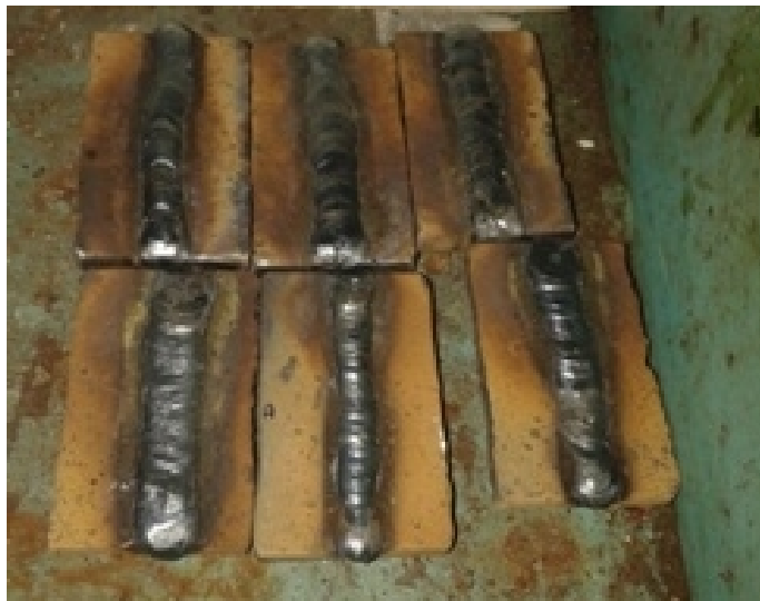
Gambar 2. Spesimen Hasil Hardfacing
