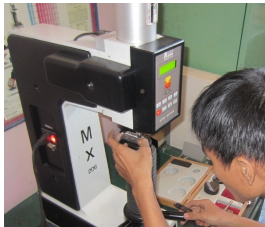
Gambar 4. Proses Pengujian Kekerasan
