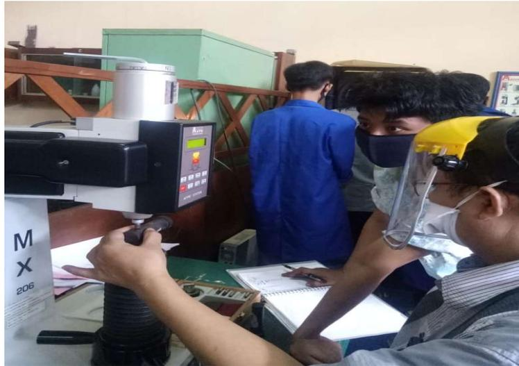
Gambar 3.7 Uji kekerasan dengan menggunakan metode *Hard Brinell*
