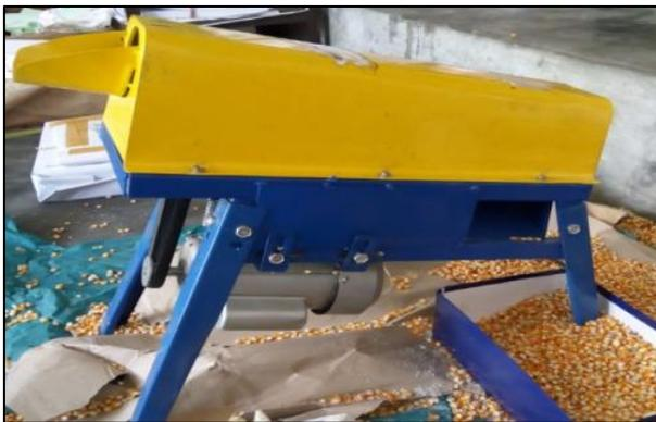
Gambar 1. Mesin pemipil jagung kapasitas 125 Kg/jam
