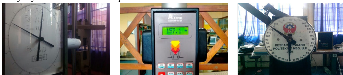
Gambar 2. Mesin uji tarik, uji kekerasan, dan uji dampak yang digunakan pada pengujian sifat Baja St37
