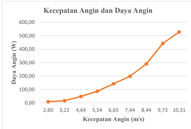
Gambar 4.9 Grafik Hubungan antara Kecepatan Angin dan Daya Angin
