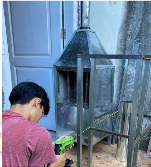
Pembuatan Rangka Ruang Pengering
