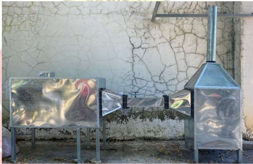
Gambar 4.1 Hasil Rancang bangun dan pengujian alat pengering gabah tipe rak berbahan bakar biomassa berbasis mikrokontroler.
