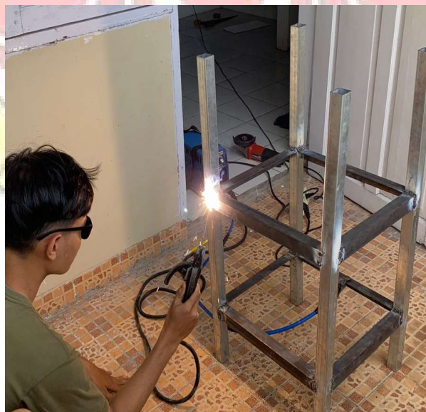
Pengelasan Rangka Hollow dan Plat Ruang Pembakaran
