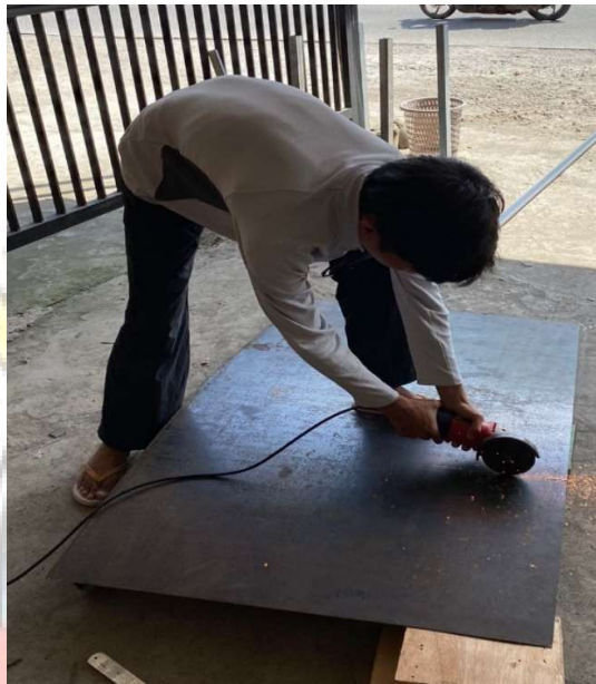
Pemotongan Plat Ruang Pembakaran
