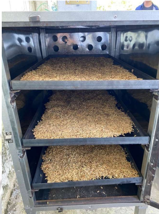
Pengisian Gabah Pada Ruang Pengereng
