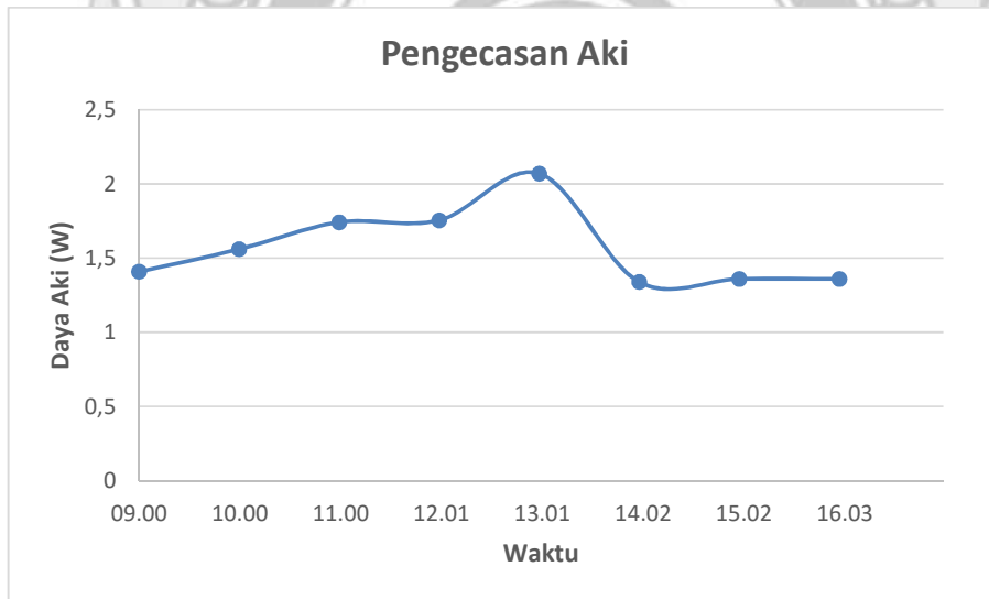
Gambar 4.7 Grafik hubungan antara Daya (Watt) dengan Waktu (Jam) pada Aki
