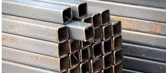
Gambar 2.3 Besi Hollow 4x4 Sumber : Ovan Zaihnuhin, 2021.
