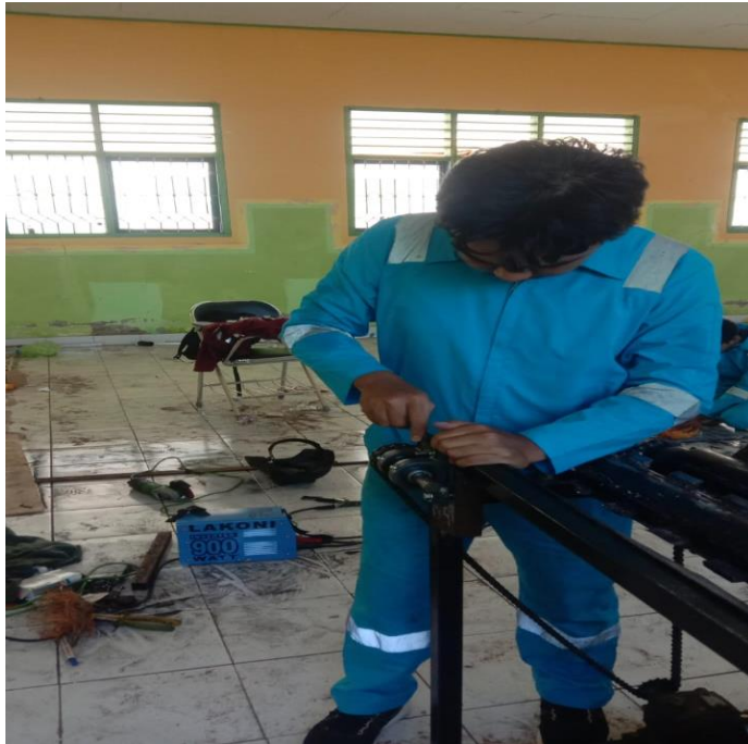
Proses pengencangan baut pada bearing duduk
