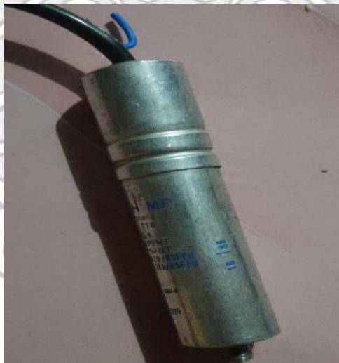
Gambar 4.1 Kapasitor yang rusak
