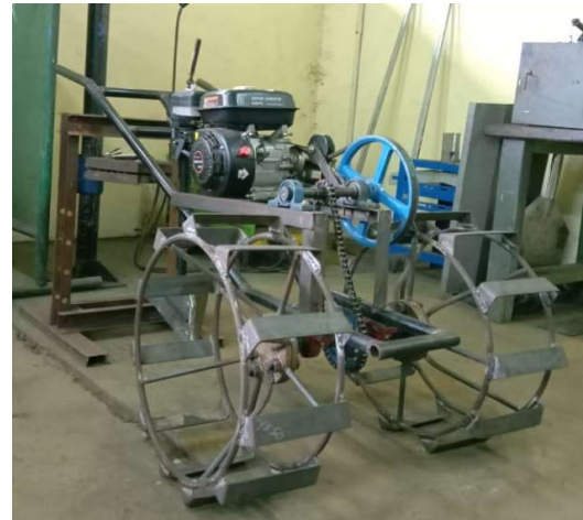
Gambar 4. Hasil perakitan komponen mesin penggembur tanah.
