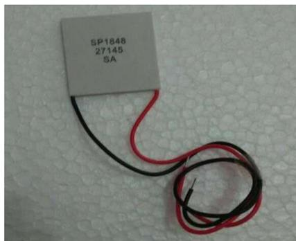
Gambar 13. Termoelektrik tipe TEG SP1848-27145
