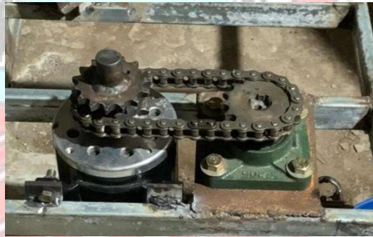
Gambar 4. 2 Mekanisme belok kanan dan kiri
