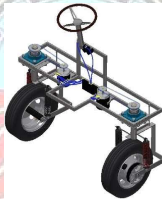
Gambar 3.7 Desain sistem kemudi mobil listrik tampak samping
