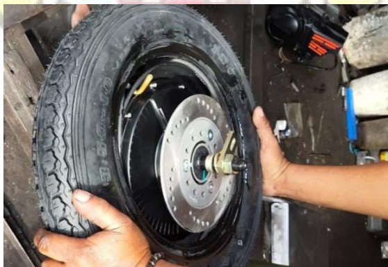
Gambar proses pemasangan BLDC
