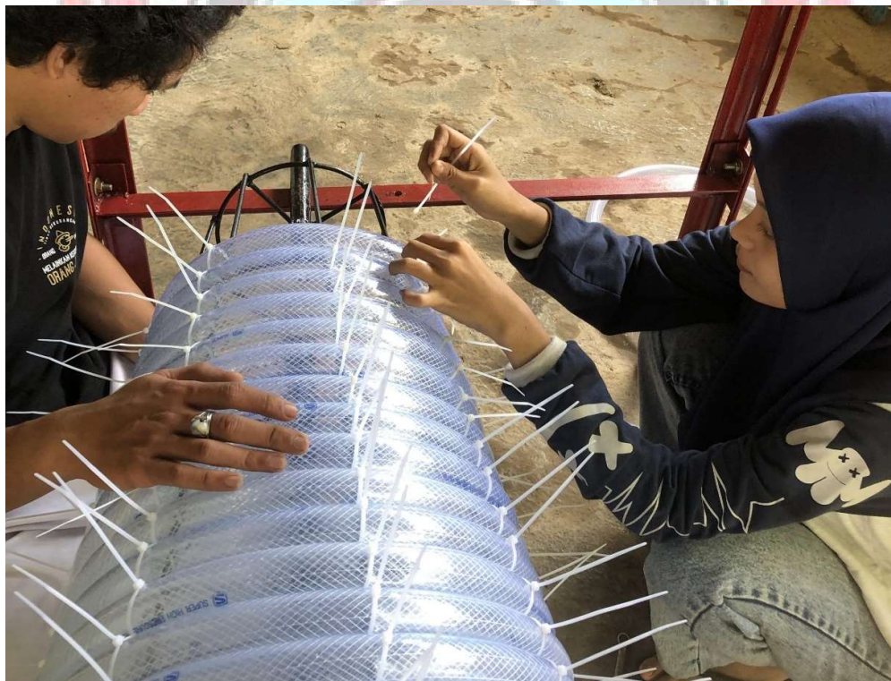
Pemasangan selang pada kerangka pompa sling
