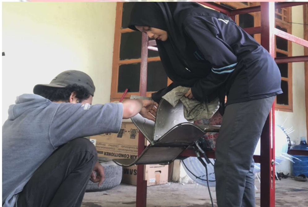
Pemasangan blade pada pompa sling
