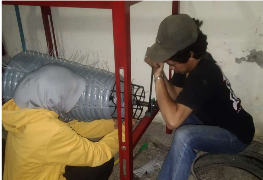
Pemasangan pompa sling ke Rangka alat
