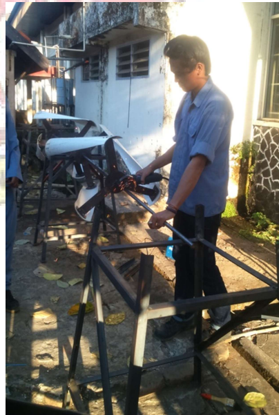
Proses pemasangan blade
