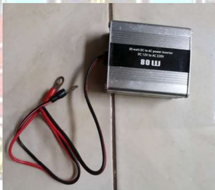
Gambar 2.6 Inverter ( Dokumentasi Peralatan )
