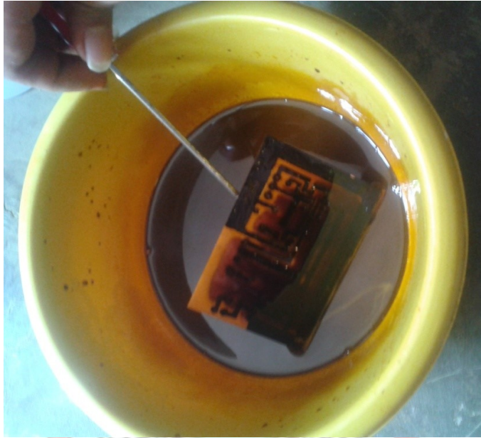
Lampiran 1. Proses pelarutan jalur pada papan PCB.
