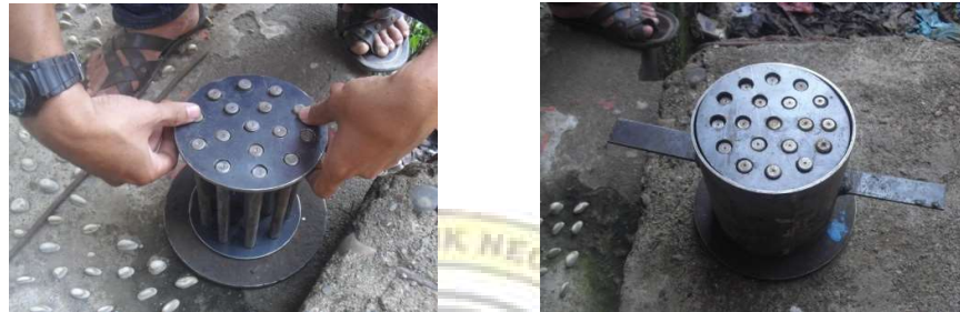
Gambar 6. Hasil rancang bangun plat alas bawah dan alas permukaan pada lubang silinder cetakan
