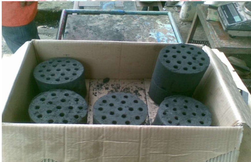
Gambar 15. Hasil cetakan briket sarang tawon lubang 19 dan 16
