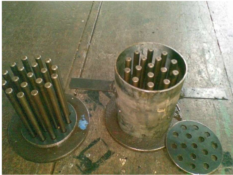
Gambar 14. Hasil rumah cetakan dan cetakan briket
