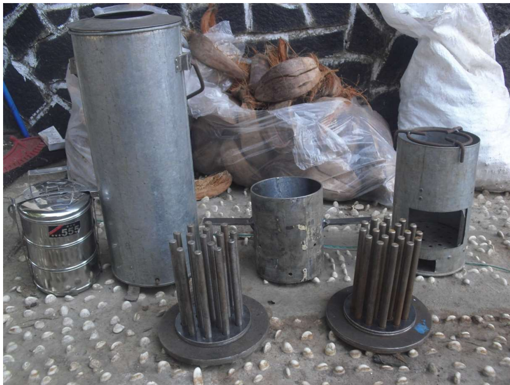
Gambar 4. Hasil rancang bangun kompor dan cetakan
