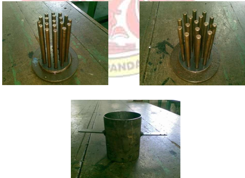
Gambar 5 . Hasil rancang bangun cetakan beriket pada lubang 19 dan 16
