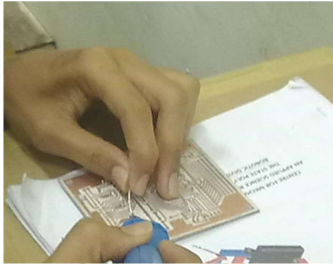
Proses pemasangan komponen
