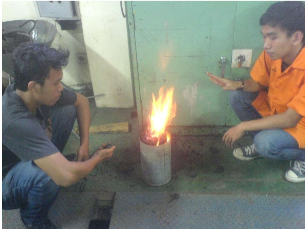
Briket diberikan minyak tanah sedikit pada bagian bawah untuk menyalakan api
