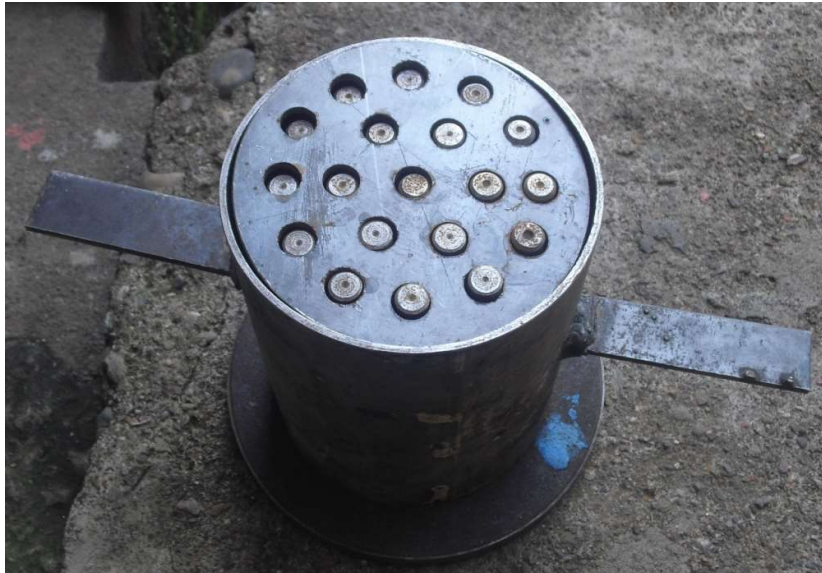
Adonan arang dicetak dengan alat pencetak briket
