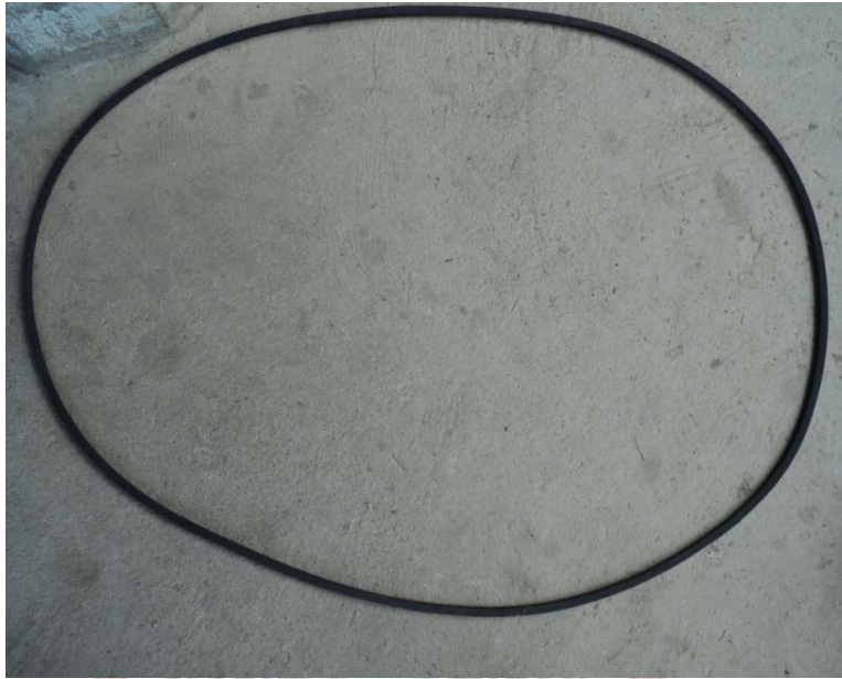
V-Belt ukuran 106 A yang digunakan untuk pulley 1
