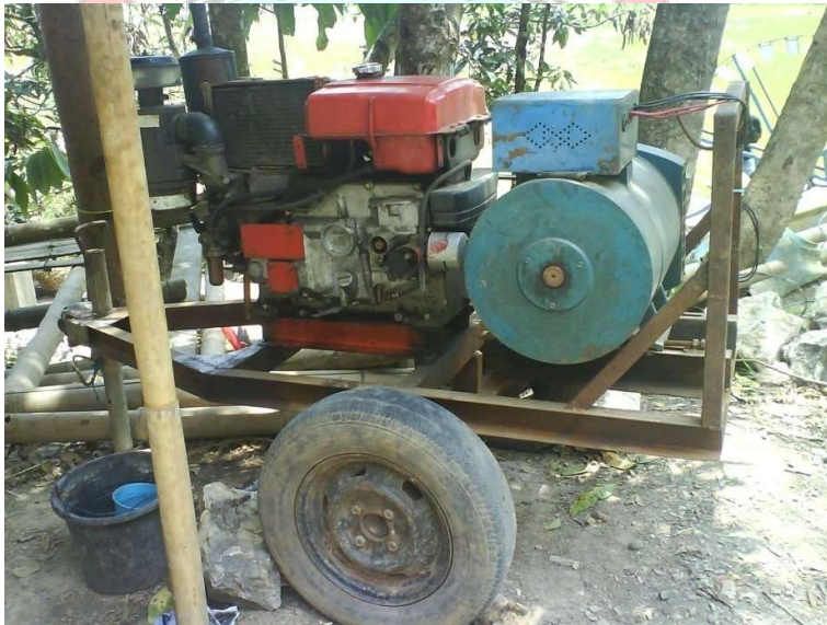
Generator yang dipalkai untuk mengelas
