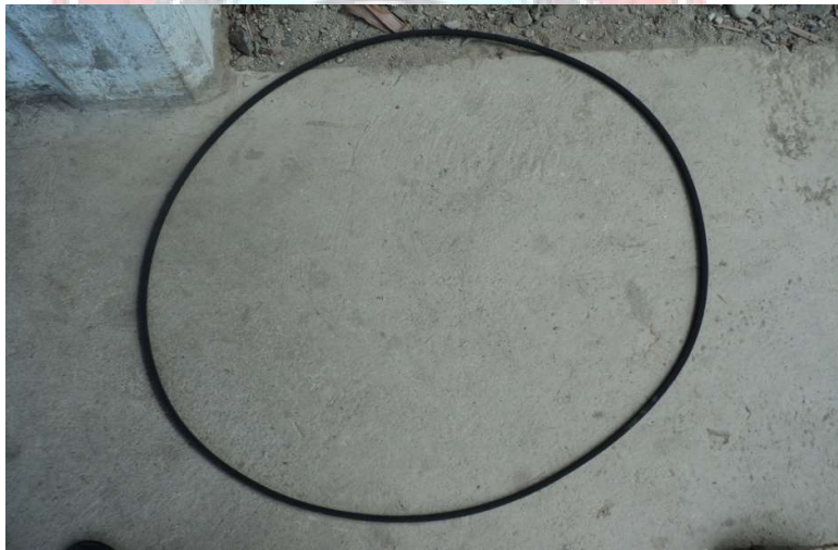
V-Belt ukuran 100 A yang digunakan untuk pulley 2
