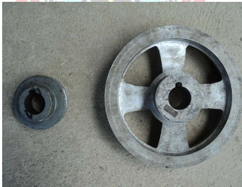
Pulley 2 (kiri) dan Pulley 1 (kanan)
