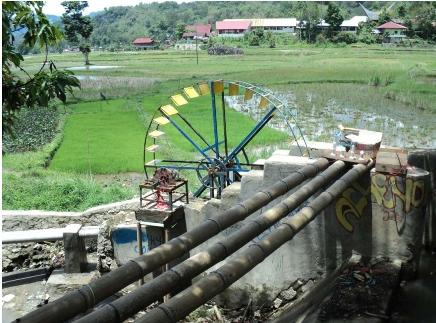
Kincir setelah dipasangi generator fiberglass
