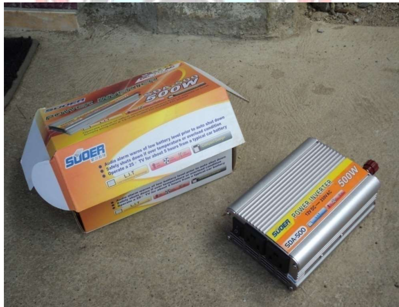
Inverter untuk menaikkan tegangan dari 12 V DC menjadi 220 V AC
