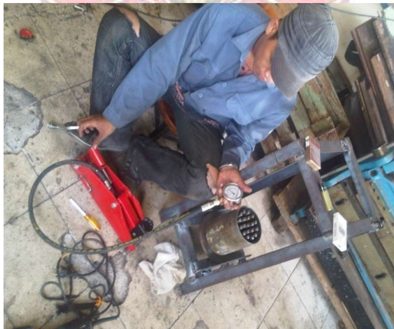
Gambar 11. Pemasangan alat ukur pada dongkrak
