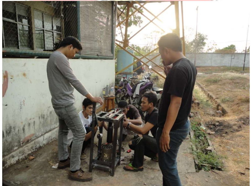
Gambar 13. Alat pencetak briket dengan sistem hidrolik
