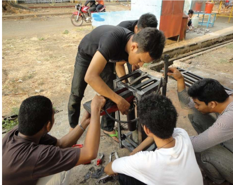
Gambar 12. Pemasangan dongkrak pada rangka
