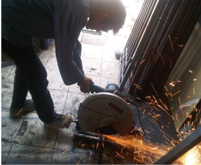
Gambar 8. Pembuatan rangka dongkrak hidrolik
