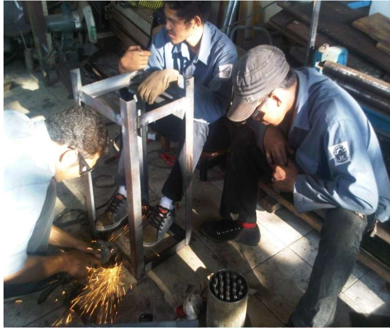
Gambar 10. Pembuatan rangka dongkrak hidrolik
