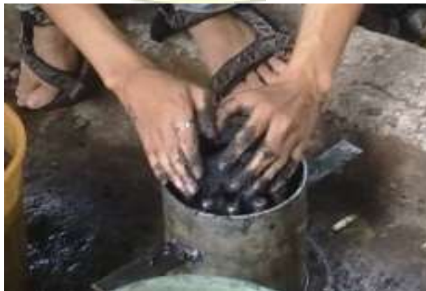
Gambar 6. Campuran dimasukkan kedalam cetakan
