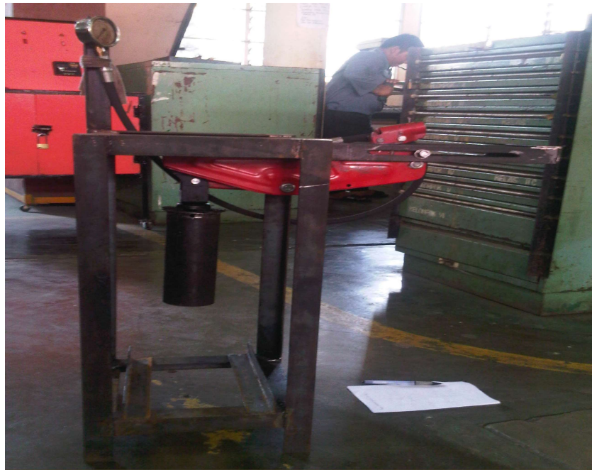
Gambar 14. Alat pencetak briket dengan sistem hidrolis
