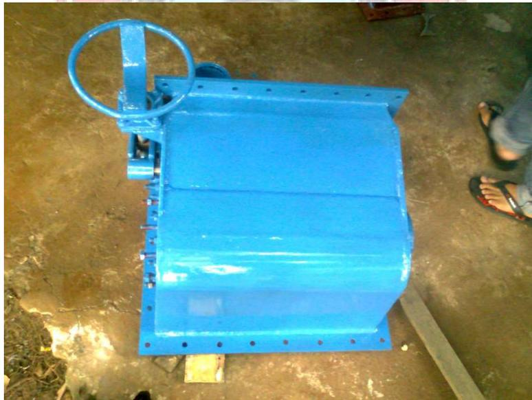
**Gambar 8. Casing turbin tampak atas yang sudah dicat**
