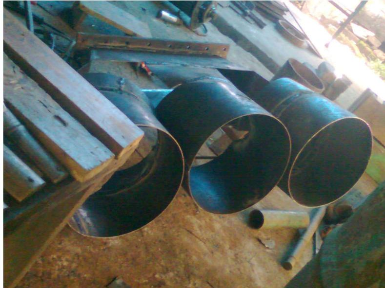
Gambar 5. Proses pembuatan sambungan pipa (*Adaptor*)
