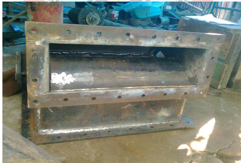
Gambar 6. Proses pembuatan casing runner
