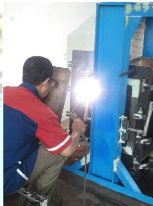
Gambar 3.9 Pengelasan handle pada pintu sisi kiri
