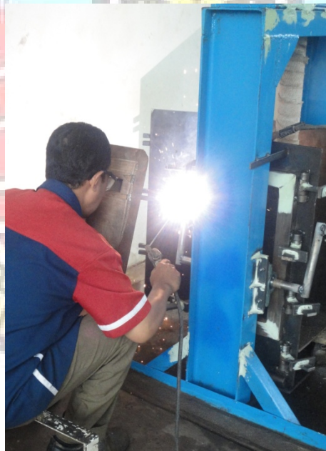
Gambar 6.14 Proses Pengelasan handel Pembuka Kotak Kemasan Bagian Samping Kiri (Plat Pembuka Kotak Kemasan)
