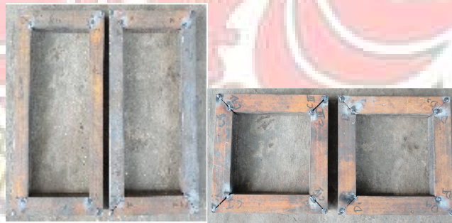
Gambar 3.8 Bentuk tulang penguat yang terpasang di sisi bagian pintu depan, samping kiri dan pintu belakang
