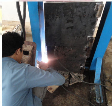
Gambar 3.6 Pengelasan kotak kemasan pada rangka bagian bawah
