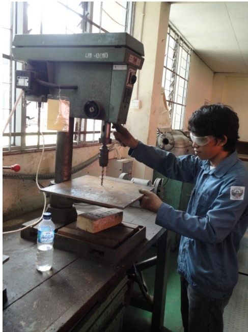
Gambar 6.9 (a) Proses pelubangan material ( boring ) dinding kotak kemasan bagian samping kiri dan kanan
