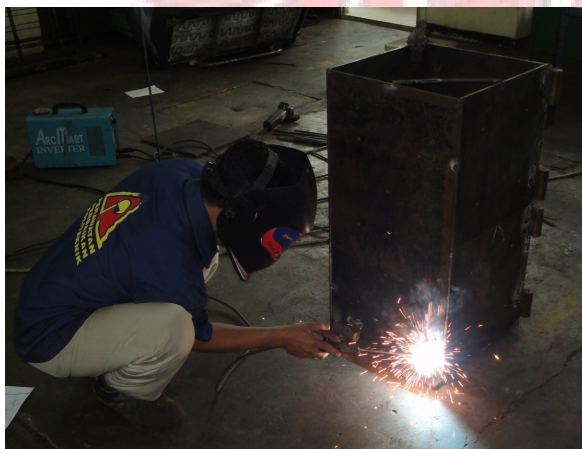
Gambar 6.10 (a) Proses pembuatan (Pengelasan) Kotak Pengemasan Rumput Laut Kering
