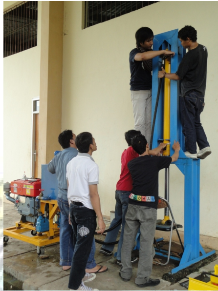
Gambar 6.11. Proses pemasangan pipa hidrolik Penekan untuk Pemasangan Kotak Kemasan
