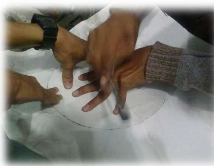
Proses Pembuatan Mall Pipa Selongsong
