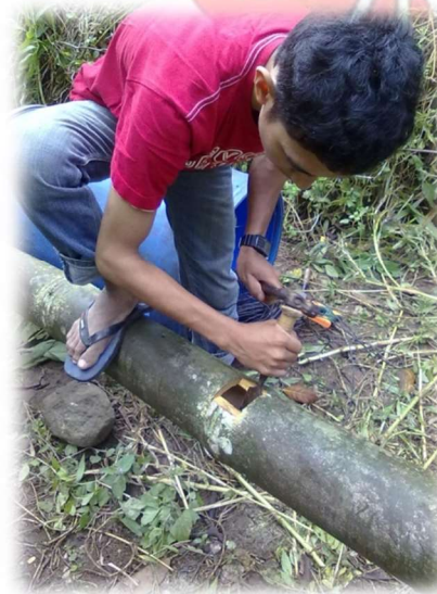
Proses Pemahatan untuk menghilangkan tulang bagian tengah
