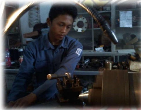
Proses Pembubutan badan turbin
