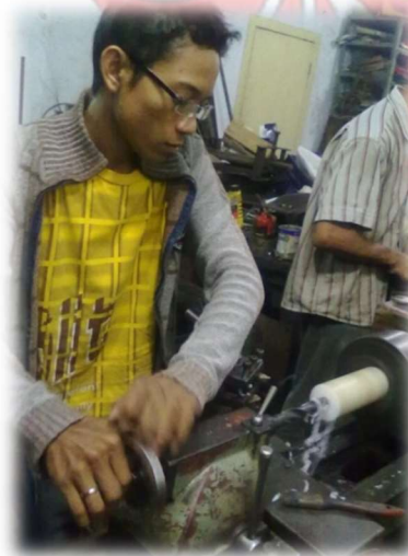
Proses Pengeboran Bahan Nilon yang akan digunakan sebagai bushing
