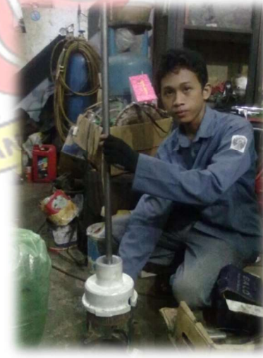
Hasil Perakitan Sementara antara Dudukan generator terhadap Poros
