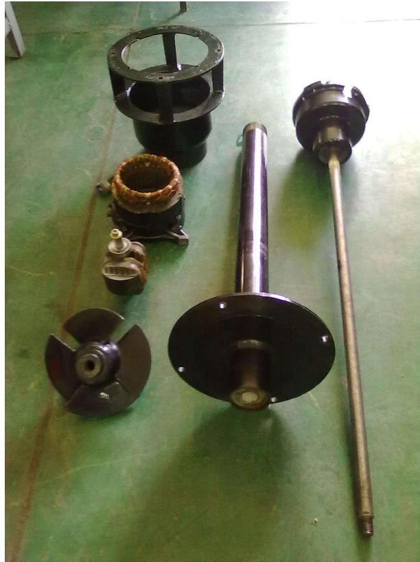
Gambar 9. Komponen picohydro yang telah siap untuk dirakit.
