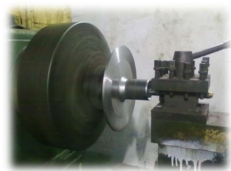
Proses Pembubutan dan balancing pipa selongsong
