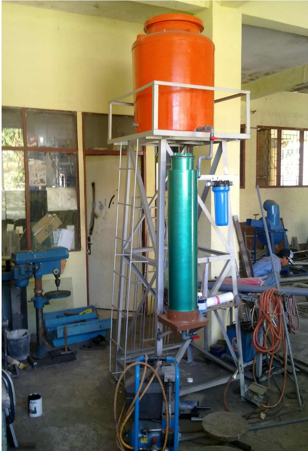
**Lampiran 4. Rangka, Profil Tank, Tabung Silika dan Filtrasi Alat Penjernih Air dengan Proses Filtrasi**
