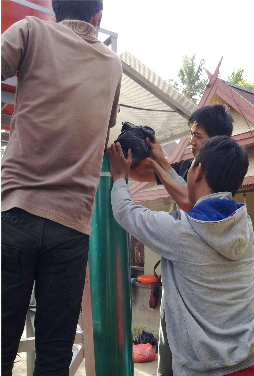
**Lampiran 10. Proses Penambahan Pasir Kuarsa dan Karbon Aktif pada Tabung Silika Alat Penjernih Air dengan Proses Filtrasi**
