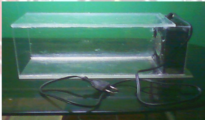
Foto 2. Saluran udara masuk menggunakan Fan.
