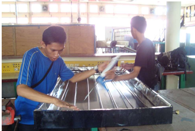
Foto 2. Kolektor dengan Diameter Pipa 3/8 inch
