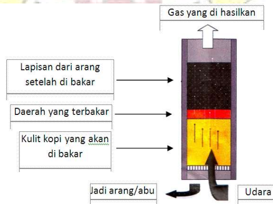
Gambar 2 Prinsip Kerja Kompor Gas Berbahan Bakar Kulit Kopi.
