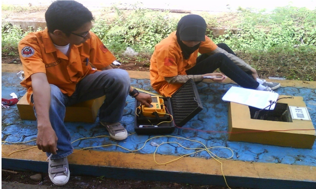
Lampiran 31. Nampak seorang mahasiswa membaca alat ukur pentanahan/earthtester
