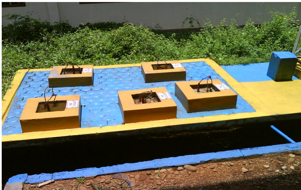
Lampiran 41. Gambar keseluruhan elektroda plat dengan 5 variasi ukuran luas yang berbeda.
