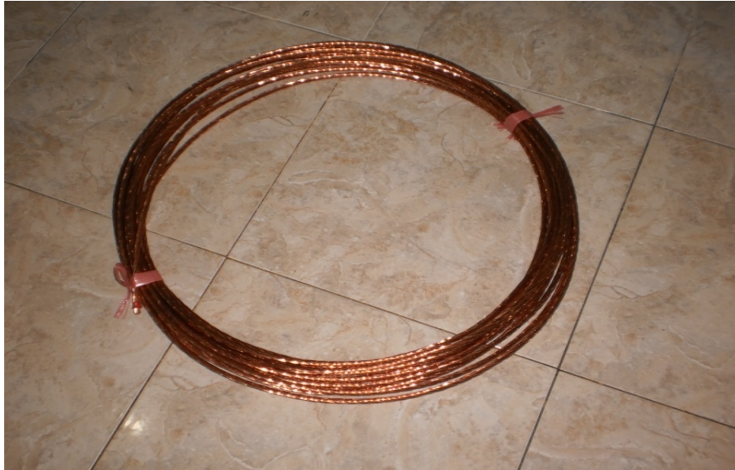
Lampiran 3. Gambar kabel jenis BC 50 mm / Kabel Tembaga
