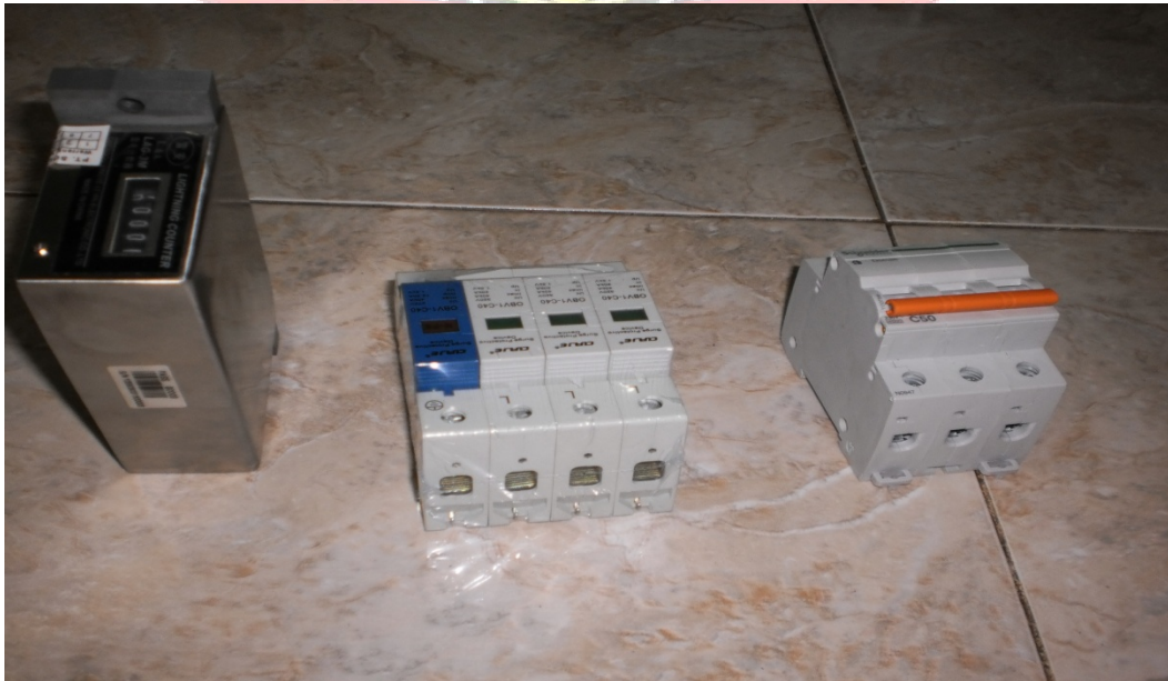
Lampiran 2. Lightning Counter, Arrester dan MCB yang digunakan
