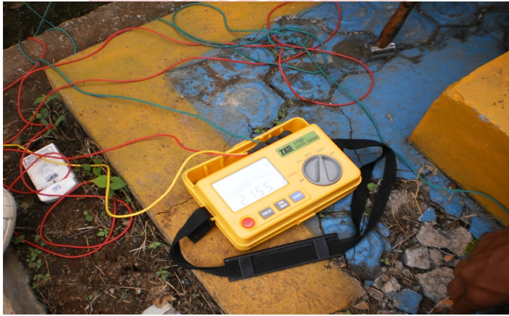
Lampiran 38. Alat yang digunakan dalam pengambilan data tahanan pentanahan yang dikenal dengan nama Earth tester.
