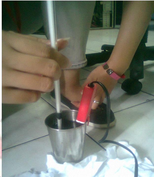
Lampiran 7. Proses Pemanasan dan mengukur suhu Minyak Transformator dengan menggunakan Heater dan Termometer.
