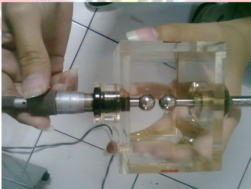
Lampiran 6. Pengaturan skala atau jarak dari dua buah elektroda
