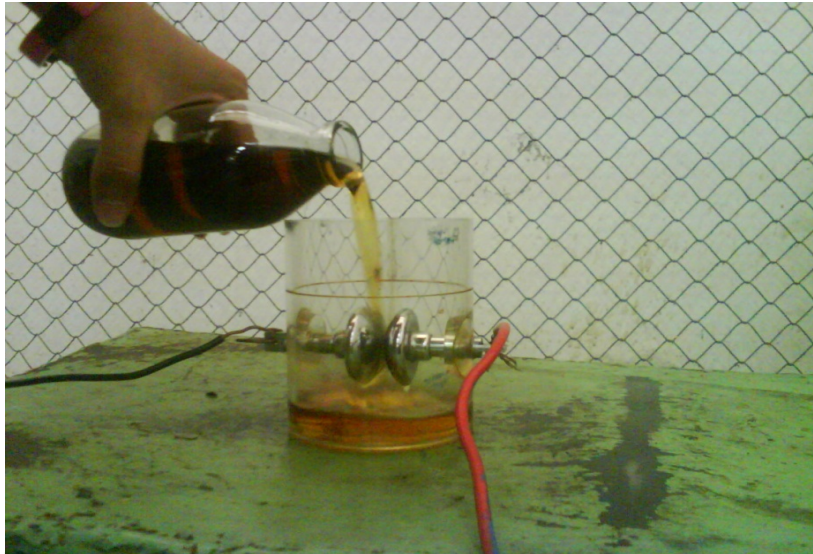
Lampiran 13. Penuangan Minyak Transformator dalam Gelas Pengujian
