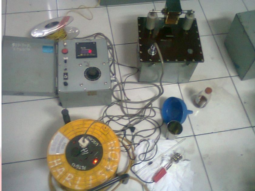
Lampiran 1. Alat dan Bahan yang digunakan pada Pengujian Tegangan Tembus di PLTU Sektor Tello
