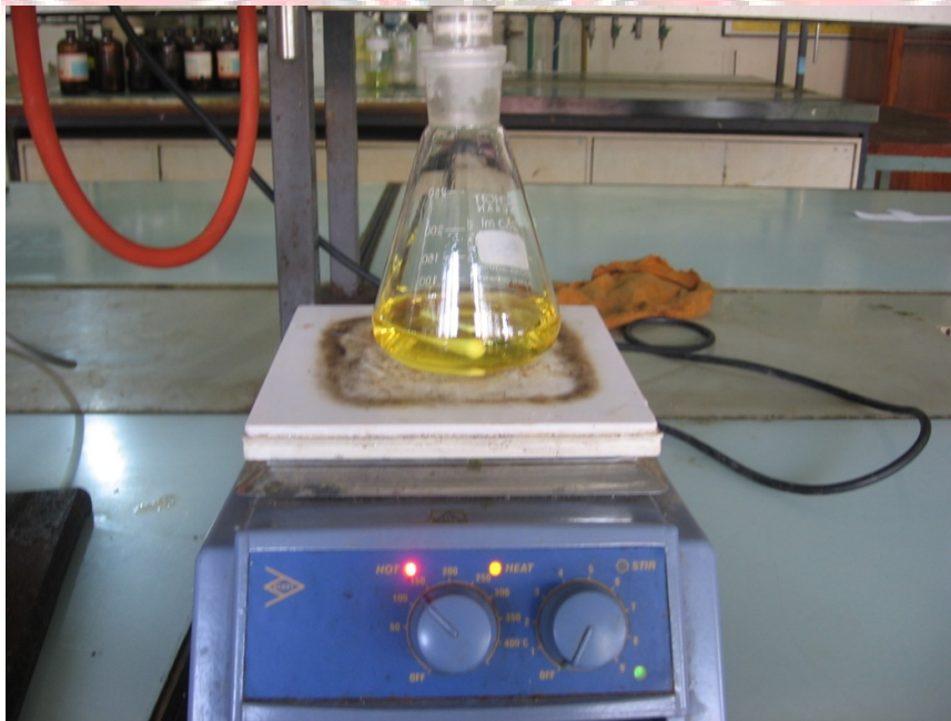
Lampiran 28. Proses Pemanasan Minyak Transformator Bekas
