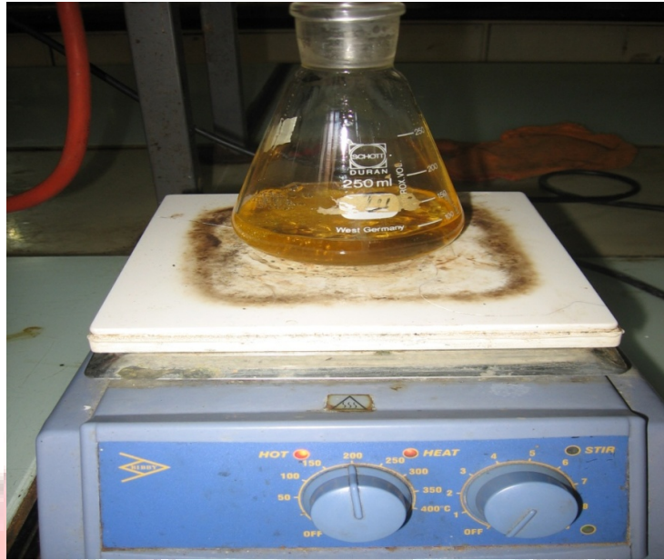
Lampiran 29. Proses Pendidihan Minyak Transformator Bekas
