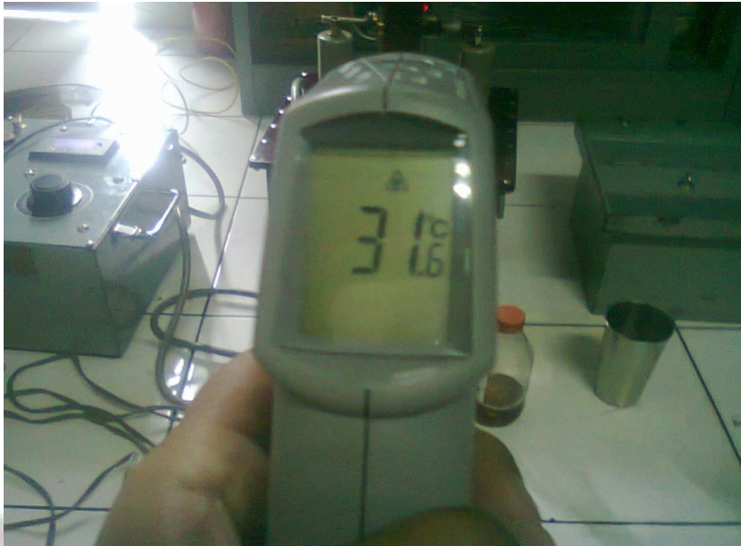
Lampiran 5. Pengetesan temperatur minyak dalam bejana dengan menggunakan thermo laser.
