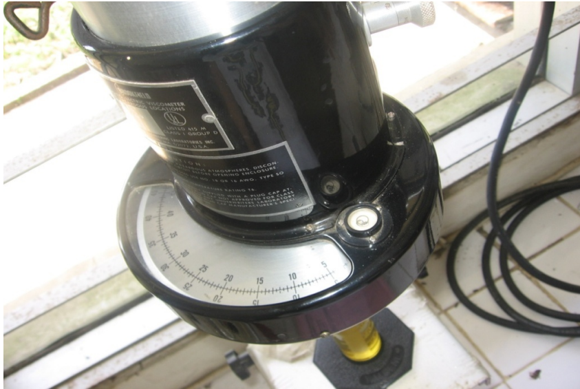
Lampiran 21. Pembacaan Skala Viscometer Brookfield setelah Pengujian
