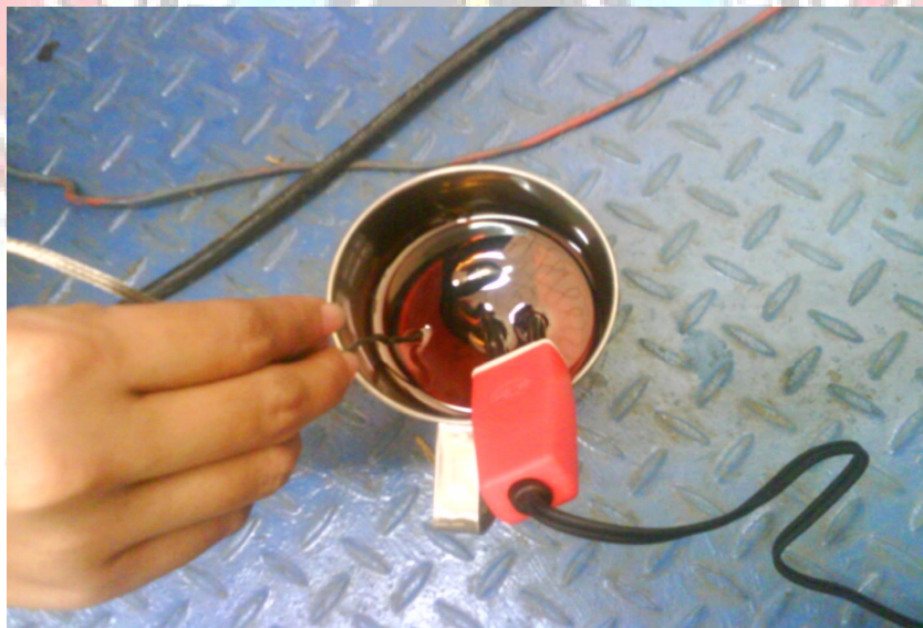
Lampiran 14. Proses Pemanasan atau Peningkatan Temperatur Minyak Transformator dengan menggunakan Heater
