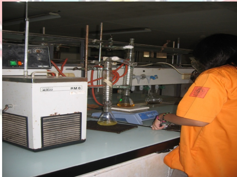
Lampiran 30. Proses Pendinginan dan Pemanasan Minyak Transformator Bekas
