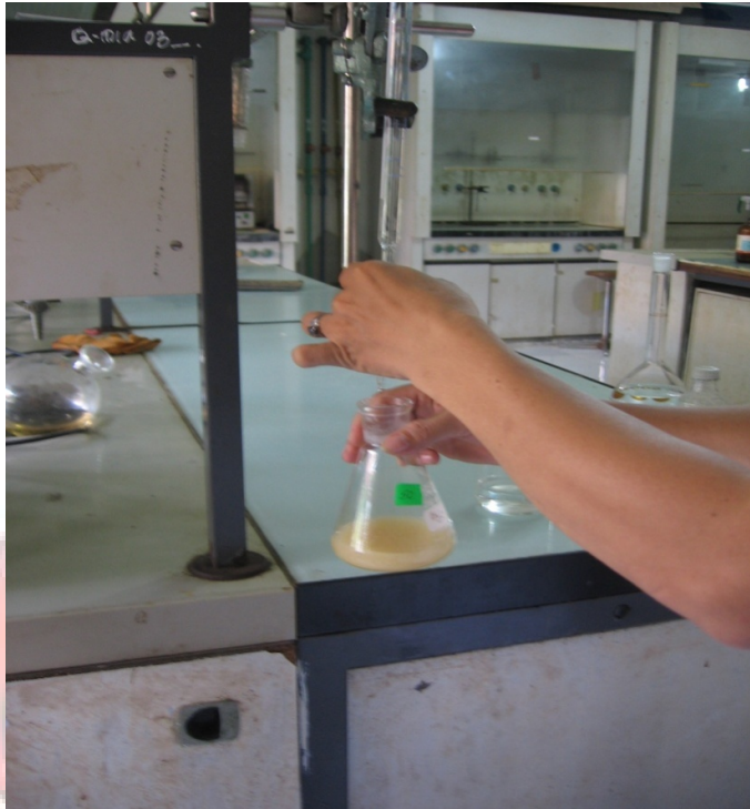
Lampiran 35. Proses Titrasi atau Pencampuran KOH pada Minyak Bekas
