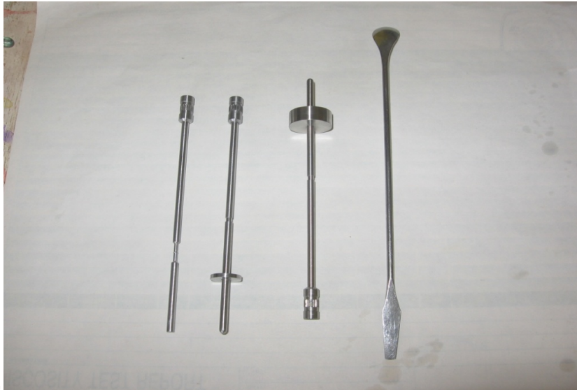
Lampiran 17. Jenis-jenis Spindel Viskometer Brookfield
