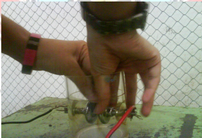
Lampiran 12. Membuat Jarak sela 2,5 mm pada Kedua buah Elektroda
