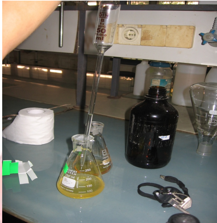
Lampiran 27. Proses Pencampuran Alkohol dengan Minyak Transformator
