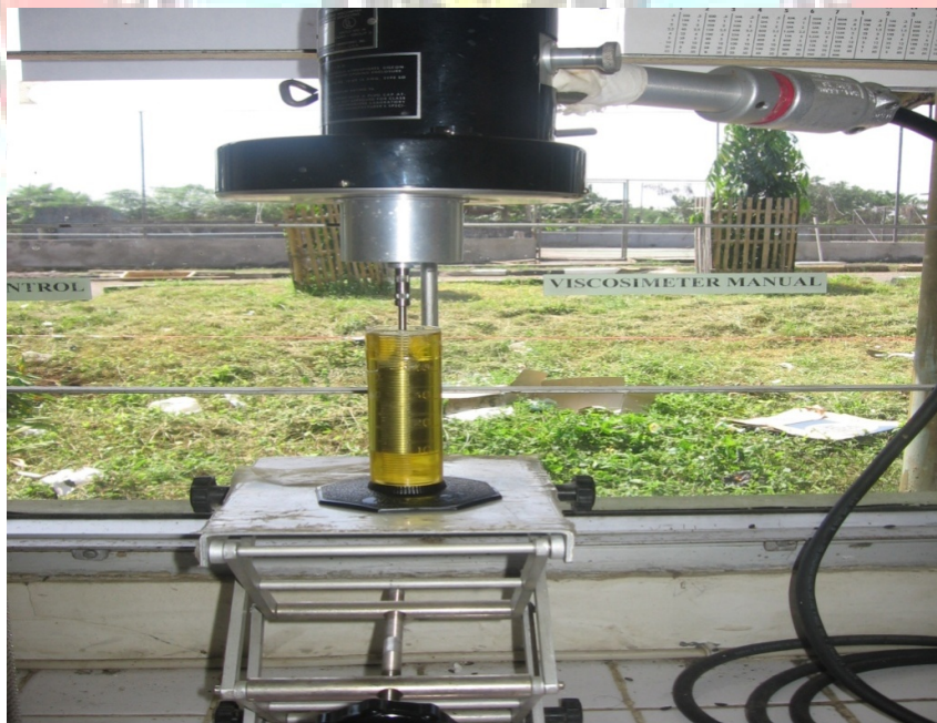
Lampiran 20. Proses Pengujian Viskositas dengan berputarnya Spindel
