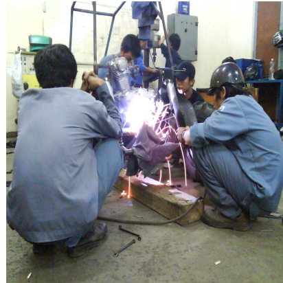
Pemasangan mesin dan dudukannya
