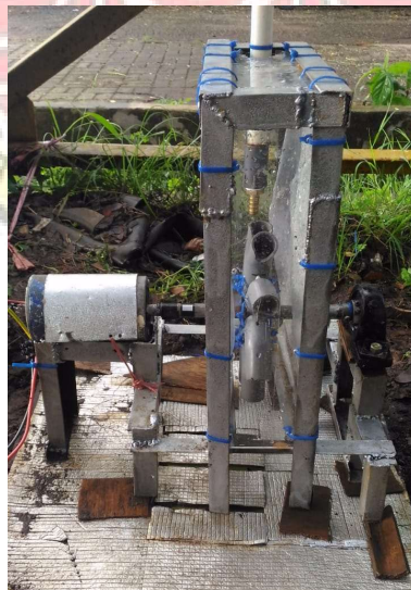
Gambar 4. Turbin Terkoppel Dengan Generator DC
