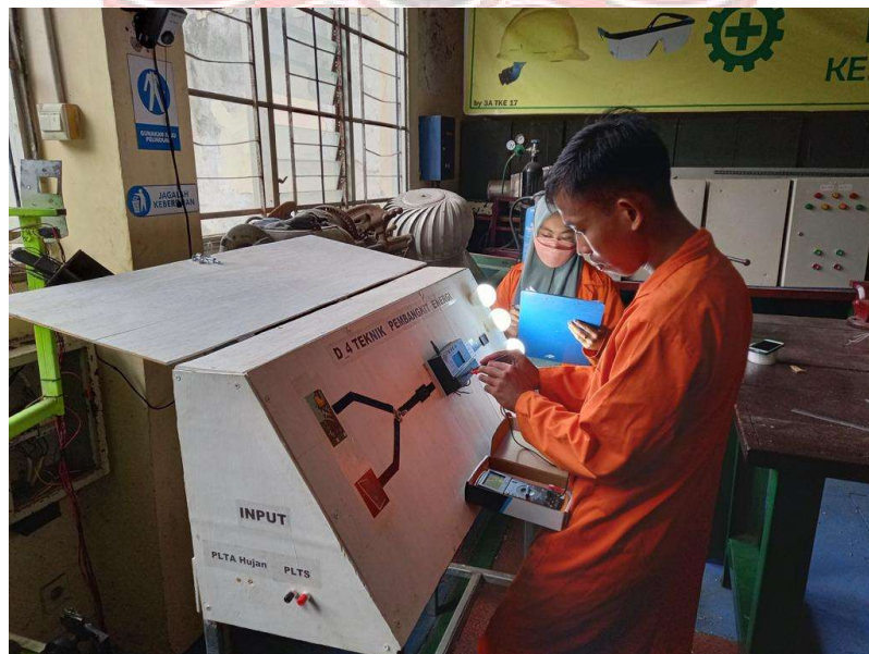
Gambar 8. Pengambilan Data Berbeban Lampu DC 12 Volt 40 Watt
