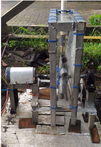
Gambar 4. 4 Turbin Pelton Tercopel Dengan Generator DC
