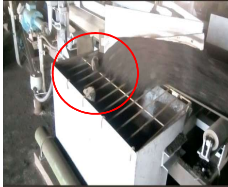
Gambar 4.7 Hasil pengujian screen hopper coal bunker dengan flow batubara 150 t/h.
