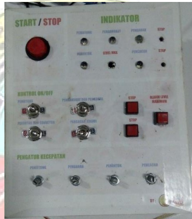
Gambar 4.3 Panel Kontrol Keseluruhan Sistem Pemanen Padi
