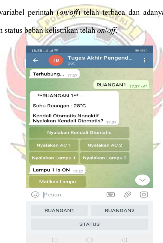
Gambar 4. 7 Koneksi aplikasi Telegram Bot dan NodeMCU ESP8266
