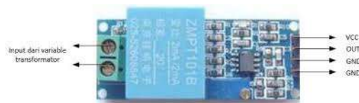
Gambar 2. 13 Konfigurasi pin sensor ZMPT101B (Sumber: Juhan, dkk, 2018)
