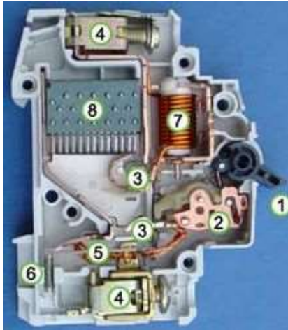
Gambar 2. 7 kontruksi MCB (Sumber: eprints.polsri.ac.id)
