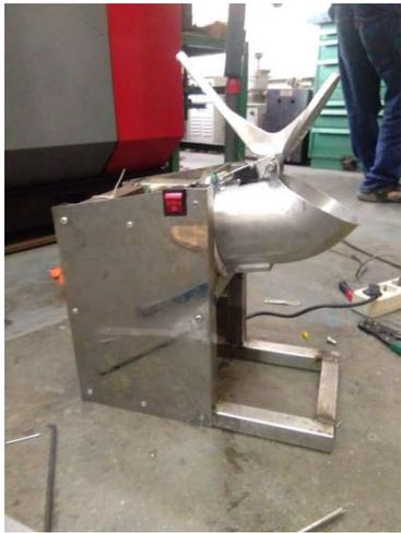
Gambar kerja 5. Perakitan limit dan pemasangan corong masuk
