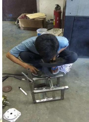
Gambar Kerja 2. Pembentukan Rangka
