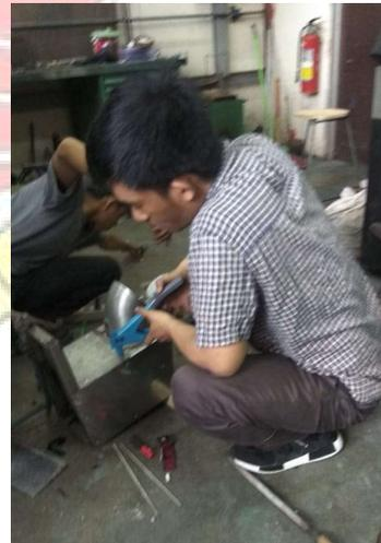
Gambar Kerja 4. Proses pengkilangan
