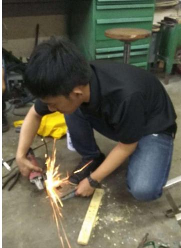
Gambar Kerja 1. Proses Pemotongan Bahan
